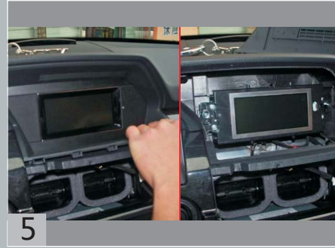
Снимите декоративные пластиковые панели экрана.
