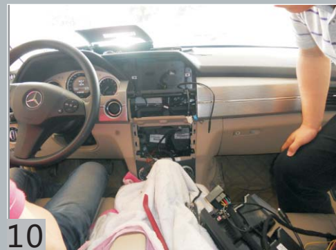
Общий вид приборной панели со снятыми дефлекторами экраном и головным устройством.
