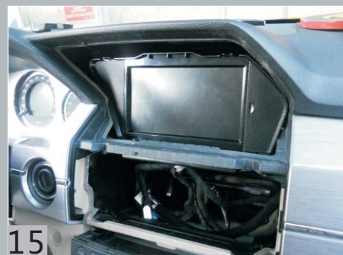
Установите на место и закрепите рамку экрана.
