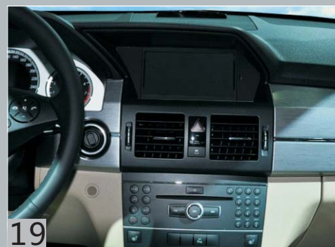
Подсоедините проводку к дефлекторам и установите его на место.
