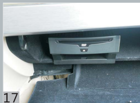
Подсоедините DVD разъем к DVD плееру и зафиксируйте его в перчаточном отделении.
