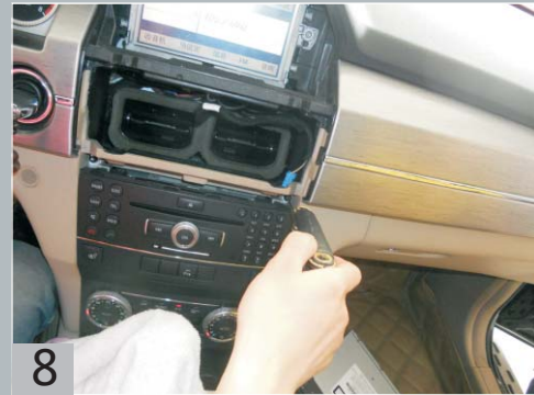
Открутите винты, крепящие штатное головное устройство.
