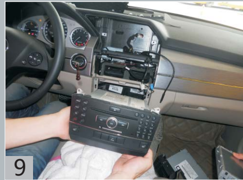
Снимите штатное головное устройство, отсоединив проводку.
