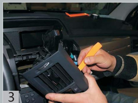
Отсоедините проводку и снимите дефлекторы.
