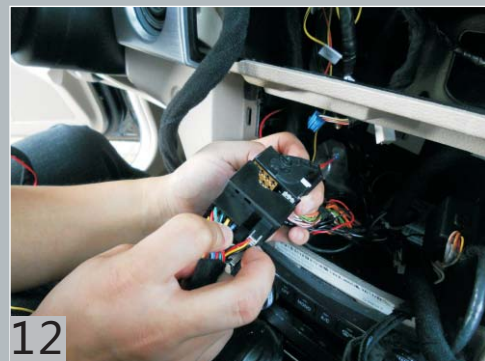
Подсоедините электропитание к новому головному устройству.
