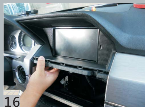
Установите на место и закрепите все штатные элементы экрана.
