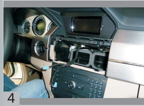
Общий вид кондиционера со снятыми дефлекторами.
