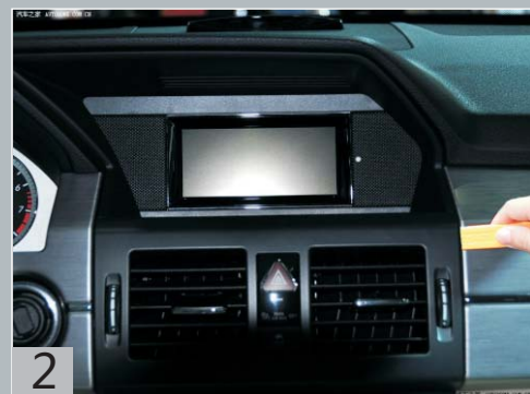
С помощью монтажных лопаток демонтируйте дефлекторы кондиционера, аккуратно снимая их с крепежных элементов.
