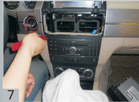
С помощью монтажных лопаток демонтируйте декоративную панель консоли.
