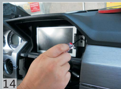
Установите новый экран и закрепите его.
