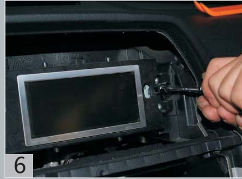
Открутите два винта, крепящие экран, снимите экран.
